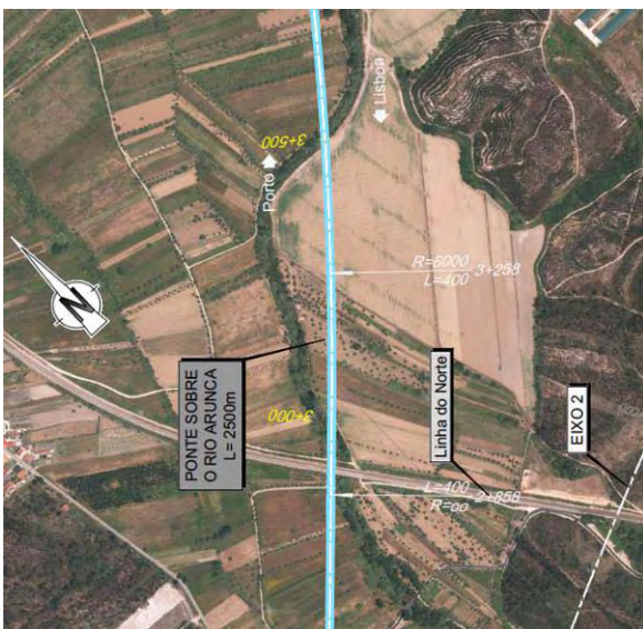
Figura 4.108 – Passagem em ponte na várzea do rio Arunca
