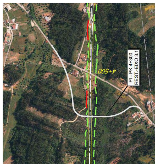
Figura 4.119 – Passagem do Eixo 1 em Casal Seco
