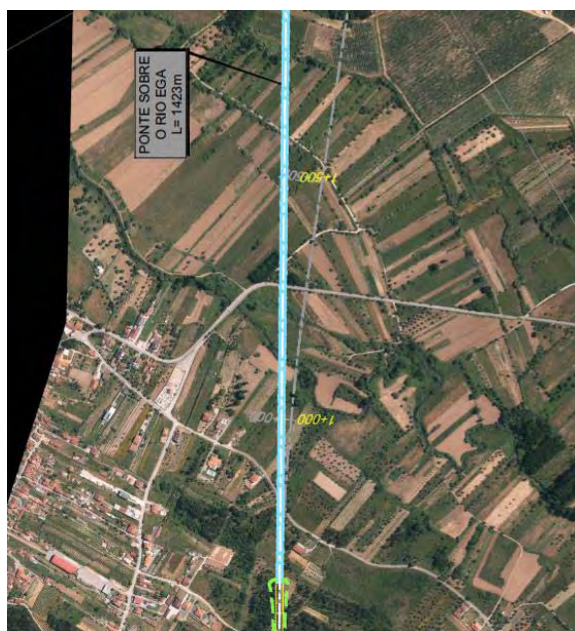
Figura 4.118 – Passagem do Eixo 1 e Eixo 2 (a tracejado) junto a Casével e atravassamento, em viaduto, da várzea do rio Ega
