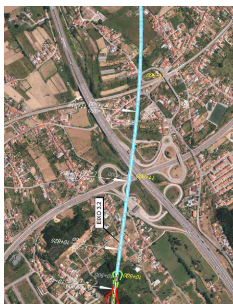
Figura 4.123 – Passagem dos Eixos 3.1 e 3.2, em ponte, em Ribeira de Frades e São Martinho do Bispo
