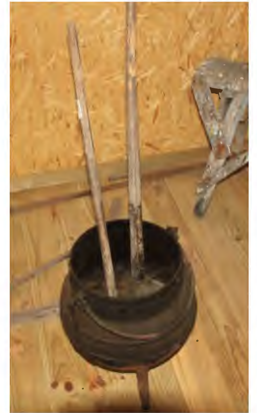
Panela e escopeiro para aplicar breu – Espólio Mestre Henrique Lavoura © Marcília Almeida, 2021
